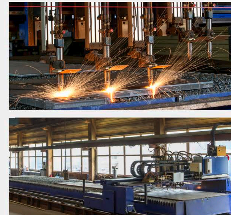
Autogen- schneidanlage mit 5 Einzelbrennern
